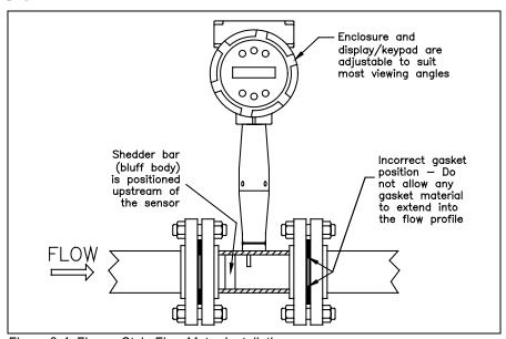
Figure 2-4. Flange-Style Flow Meter Installation
