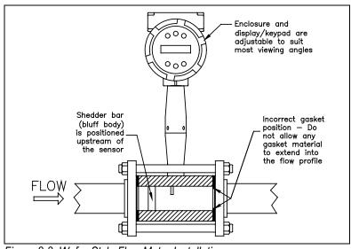
Figure 2-3. Wafer-Style Flow Meter Installation
